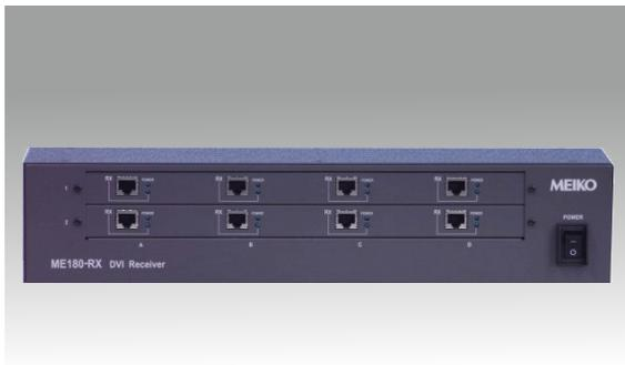
ME180-RXはDVI/HDMIツイストペア伝送器です。当社製ME100-RXをEIA2Uサイズに8ユニットを実装した製品となります。ME100-TX等の送信器とセットで使用することによりDVI(HDMI)信号をCat5e/6ケーブルで最大100mまで延長することが可能です。
