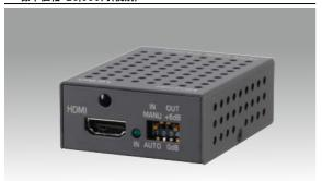
MEQ10Hは、長尺ケーブルにより劣化したデジタル信号を波形整形して出力するHDMIケーブルイコライザです。シンク機器側に接続します。 MEQ10Hを使用することにより最長で入力側50m、出力側10mの HDMI長尺ケーブルに対応可能です。
